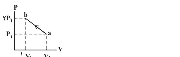
۳) اندازه گرمایی که گاز با محیط مبادله می‌کند، بزرگ‌تر از اندازه کاری است که محیط روی گاز انجام می‌دهد.
