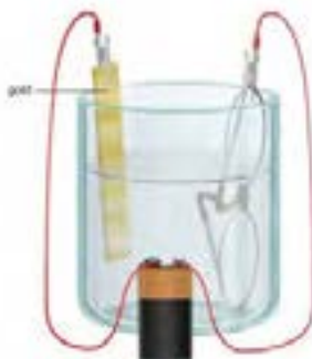
شکل ۸- آبکاری در سلول های الکترولیتی
