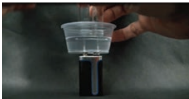
شکل ۷- الکترولیز آب، نمونه‌ای از کاربرد سلول‌های الکترولیتی
