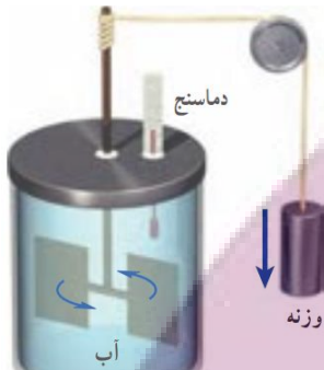
شکل ۱۷-۴ نمونه ای از آزمایش ژول : در این آزمایش نشان داده می شود کار نیروی وزن برابر با مقدار گرمای لازم برای افزایش دمای آب است.
