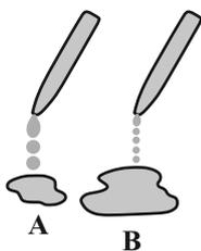
قطره‌های روغن شکل (B) می‌باشد و با افزایش دما، نیروی هم‌چسبی بین مولکول‌های روغن ... می‌یابد.
