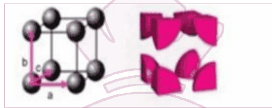
شکل ۱۰ - ساختار شبکه‌ای مکعبی ساده [2]
