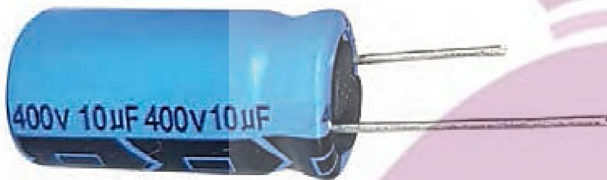
شکل - تصویری از یک خازن که روی آن ظرفیت و اختلاف پتانسیل بیشینه قابل تحمل نوشته شده است.
