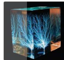
شکل - تقض های لیچنبرگ، فروریزش الکتریکی باعث تشکیل مسیرهای رسانایی سرخشی شکلی در دی الکتریک شده است.
