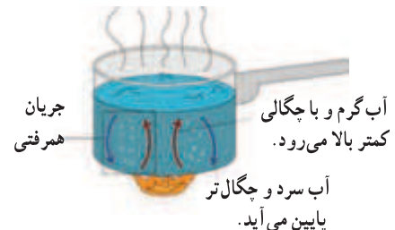
شکل - گرم شدن آب درون قابلمه به روش همرفت
