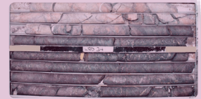
مغزه‌گیری با گمانه‌های اکتشافی
