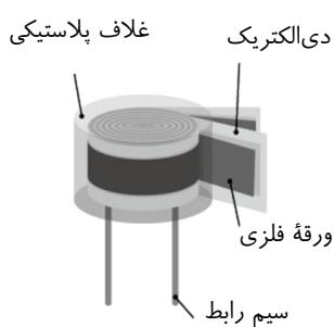
**خازن‌های میکا:** بین ورقه‌های فلزی نازک قلعی، ورقه‌های نازک میکا قرار می‌دهند و ورقه‌های قلع را یک در میان به یکدیگر وصل می‌کنند. ظرفیت این خازن‌ها حدود ۵۰۰ پیکوفاراد است.
