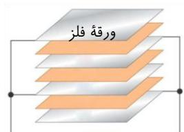
**خازن‌های ورقه‌ای:** این خازن‌ها از دو ورقه قلع یا آلومینیم تشکیل شده‌اند که بین آن‌ها دو ورقه دیالکتریک مانند کاغذ یا پلاستیک جا داده می‌شود. این ورق‌ها را لوله می‌کنند و به صورت یک استوانه در می‌آورند و در محافظه‌ای پلاستیکی قرار می‌دهند. ظرفیت این نوع خازن‌ها از  $1 \text{nF}$  تا  $1 \mu\text{F}$  است.
