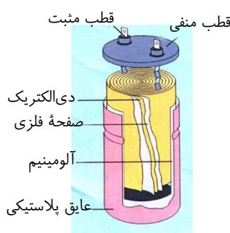
**خازن‌های الکتروولیتی:** این خازن‌ها از یک صفحه فلزی اندود شده با اکسید آلومینیوم، به طوری که صفحه فلزی قطب مثبت خازن و لایه اکسید، دیالکتریک آن باشد، تشکیل شده است. الکتروولیت جامد یا مایع (که غالباً کاغذی آغشته به مایع الکتروولیت است) به عنوان قطب منفی خازن عمل می‌کند. ظرفیت این خازن‌ها بالاست و تا حدود  $10 \text{ F}$  می‌رسد.
