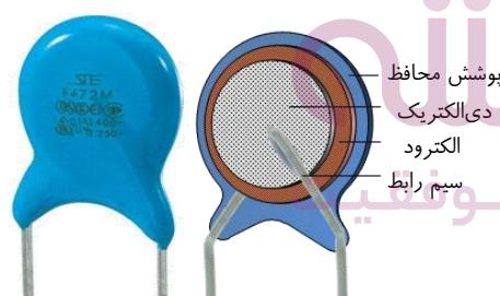
**خازن‌های سرامیکی:** دیالکتریک این خازن‌ها سرامیک است که با استفاده از انواع سیلیکات‌ها در دمای بالا تهیه می‌شود. ثابت دیالکتریک این خازن‌ها زیاد و در حدود ۱۰۰۰ است. خازن‌های سرامیکی به شکل عدس تهیه می‌شوند و حجم آن‌ها کم است. صفحه‌های رسانای آن‌ها نیز با ذوب نقره در دو طرف سرامیک تهیه می‌شود. ظرفیت این خازن‌ها حدود دهانه نانوفاراد (nF) است.
