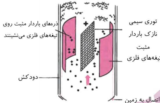
پاک کننده هوای الکتروستاتیکی دستگاه مشابه دیگری از این دست به منظور ایجاد هوای مطبوع برای مبتلایان به آلرژی است. در این دستگاه، هوای آلوده نخست از میان یک شبکه توری با بار مثبت عبور داده می‌شود. ذرات آلودگی با برخورد با این شبکه باردار مثبت می‌شوند. سپس، هوا از شبکه توری دیگری که باردار منفی شده است عبور می‌کند. ذرات آلاینده که پیشتر هنگام برخورد با شبکه توری منفی می‌شوند و روی این شبکه رسوب می‌کنند و به این ترتیب هوای خروجی از دستگاه عاری از درصد زیادی از ذرات آلاینده است.
