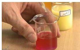
هر قطره قطره‌چکان حدود ۰/۰۵ میلی لیتر حجم دارد با شمارش قطره‌ها می‌توان حجم مصرف شده
