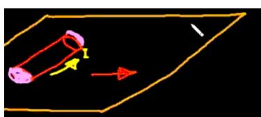
آزمایش را با یک صفحه آلومینیومی صاف که دارای اصطکاک کمی است هم می‌توان انجام داد. مجموعه آهنربا-باتری را روی صفحه آلومینیومی قرار می‌دهیم تا میدان بر جریان اثر بگذارد و به سمت راست یا به سمت چپ حرکت کند.
