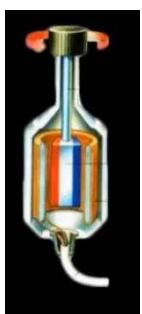
ثابت و آهن ربا متحرک است. در آرمیچر معمولاً آهن ربا ساکن است و سیم پیچ می‌چرخد. اگر آرمیچر را به باتری متصل کنیم می‌چرخد چنانچه آن را بچرخانیم برق تولید می‌کند.
