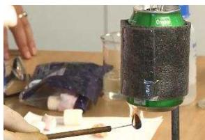
تا جایی که ماده غذایی (مغز بادام) می‌سوزد آن را زیر گرماسنج نگه میدارم تا باعث گرم شدن آن شود (در این آزمایش حدود ۸۹ درجه) اگر دمای آب زیاد شد و مثلاً به بالای ۹۰ درجه رسید مابقی ماده غذایی را خاموش کرده و مجددًا وزن می‌کنیم. (۱۲۰ گرم)
