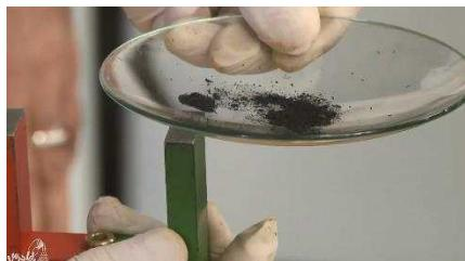
برای جداسازی آهن از آهن ربا (هر گونه آهن ربا) استفاده می‌شود. قبل از آن میتوان برای نشان دادن عدم وجود خاصیت مغناطیسی در اکسید آهن، آن را به آهن ربا نزدیک کرد. مشاهده خواهد شد که اکسید آهن جذب آهن ربا نمی‌شود. ولی آهن پس از استخراج، دارای خواص مغناطیسی است.
