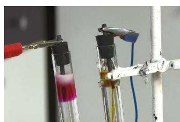
در سمتی از لوله که به قطب منفی لوله متصل است کاهش انجام خواهد شد؛ کاتیون پتاسیم و هیدروژن با هم رقابت می‌کنند و هیدروژن با توجه به جدول الکتروشیمیابی در این رقابت برنده شده کاهش میابد و به صورت گاز خارج می‌شود. به همین خاطر است که باید الکترود را به آرامی در دهانه لوله قرار دهیم تا گاز ایجاد شده به راحتی خارج شود و پرتاب صورت نگیرد. برای اینکه قابل رویت باشد. غلظت  $\text{OH}^-$  افزایش می‌یابد و رنگ ارغوانی یا بنفش ایجاد شده به خاطر خاصیت بازی ناشی از آن است.
