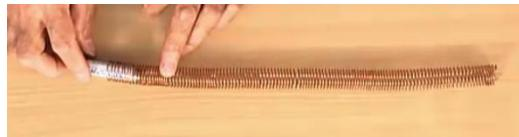
آهنرباها را اطوری که قطب‌های هم‌نام آنها به سمت باتری باشد به دو سر باتری وصل می‌کنیم. اگر باتری را از ابتدای سیم‌لوله، درون آن قرار دهیم می‌بینیم که مجموعه باتری-آهنربا به حرکت می‌افتد.
