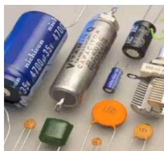
(۱) خازن یک قطعه الکترونیکی است که بار و انرژی الکتریکی را ذخیره می‌کند.
