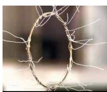
**۲.** حلقه فلزی دارای نخ را به واندوگراف متصل می کنیم. نخها هیچ شکل خاصی ندارند دستگاه را روشن می کنیم نخها به شکل خاصی و با کمی اغماض در راستای میدان که حلقه ای است آرایش پیدا می کنند و به صورت شعاعی قرار می گیرند به طوری که همه آنها در اطراف حلقه جای گرفته و نخی در سمت داخل وجود نخواهد داشت. این خود نشان می دهد که بارهای الکتریکی در سطح خارجی قرار دارند.
