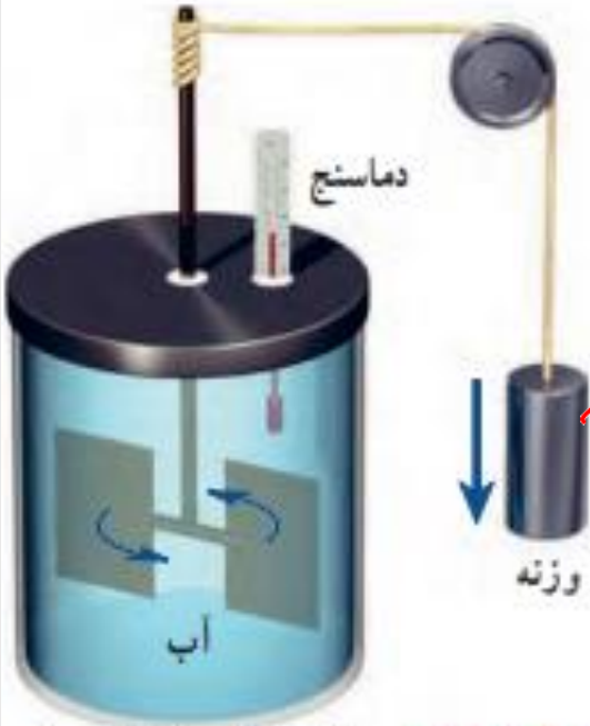
شکل ۴-۱ نمونه‌ای از آزمایش ژول؛ در این آزمایش نشان داده می‌شود کار نیروی وزن برابر با مقدار گرمای لازم برای افزایش دمای آب است.
