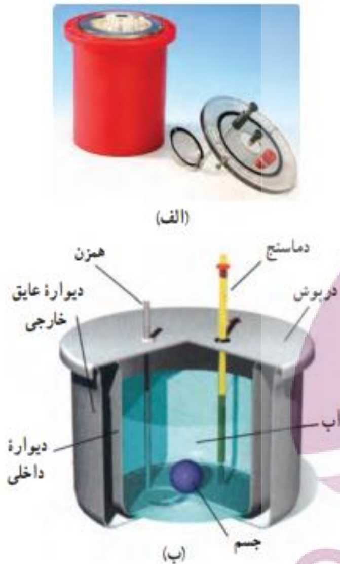
شکل ۴-۱۹ (الف) عکسی واقعی و (ب) طرحی از نمای داخلی یک گرماسنج
