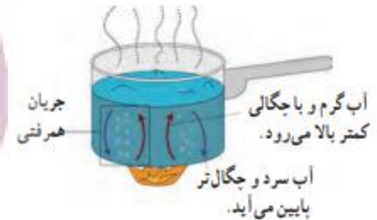
شکل ۳۴ - ۳۲ گرم شدن آب درون قابلمه به روش همرفت
