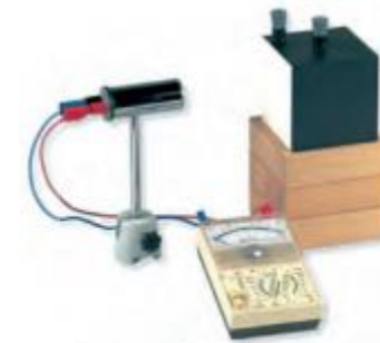
شکل ۴-۳۴ درون مکعب لیلی، آب داغ می‌ریزند. تابش گرمایی از چهار وجه مکعب که رنگ‌های متفاوتی دارند، با هم فرق دارد.
