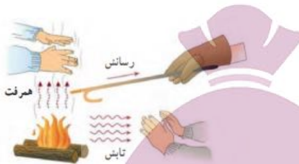
شکل ۱۴-۱۵ هر سه روش انتقال گرما را در این تصویر مشاهده می کنید.
