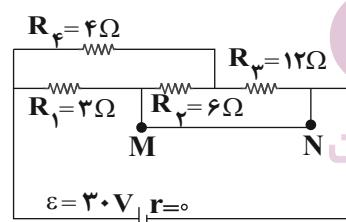
۱۹۵ - در مدار شکل مقابل، جریان عبوری از سیم MN چند آمپر است؟
