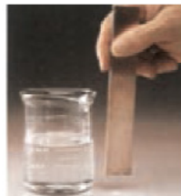
تیغه مسی درون محلول روی سولفات پس از مدت طولانی.
