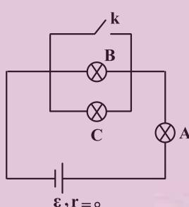
ب) اختلاف پتانسیل دو سر B و C به اندازه ۵۰ درصد کاهش می‌یابد.
