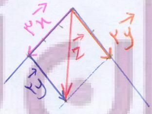
برای رسم بردار  $(\vec{c} = k\vec{a} + l\vec{b})$  ابتدا از یک نقطه دلخواه بردار  $k\vec{a}$  را رسم راستا با بردار  $\vec{a}$  و  $l\vec{b}$  را رسم راستا با بردار  $\vec{b}$  کنیم.
