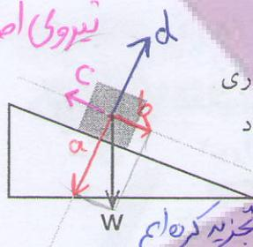
بیش تر باشد مولفه ی نیروی  $\vec{a}$  در شکل روبه رو نیروی وزن جعبه، که روی سطح شیب داری قرار گرفته، نشان داده شده است. این بردار را روی دو امتداد رسم شده تجزیه کنید. بردار وزن  $\vec{W}$  را به دو بردار  $\vec{a}$  عمود بر سطح  $\vec{b}$  در راستای سطح شیب دار تجزیه کرده ایم
